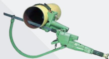
**Seghe alternative** (5 1212 0010, 5 1232 0050, ...) pneumatiche, idrauliche, elettriche per taglio in opera tubi acciaio.
