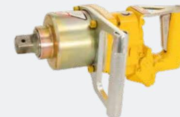
**Avvitadadi idraulici** (6 1520 0010, 6 1515 0010, ...) ad impulsi, circuito aperto, coppie di serraggio fino a 2.500 Nm. Attacchi quadri da ¾ e 1 pollice.
