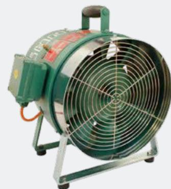
**Ventilatori Assiali** (8 1020 0140, ...) elettrici trifase, spec. per aree esplosive Ø DN 300 mm e grado di protezione IP55. Necessaria la messa a terra.
